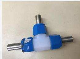
Fig. 1. Modelo de conexión T Tsagelok utilizada para construir herméticamente las celdas estudiadas.
